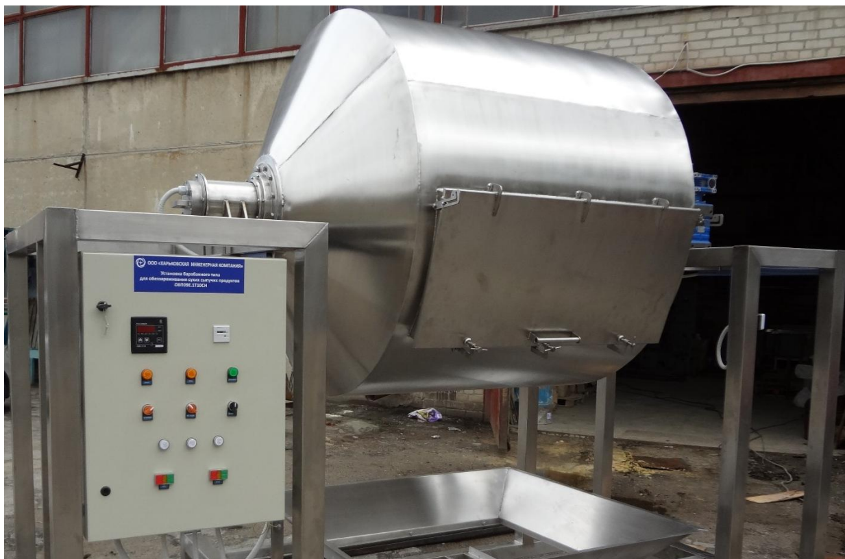
Рис. 4. Установка роторного типа БОЗОН-М для обеззараживания зневодненого осаду озоном [7]
