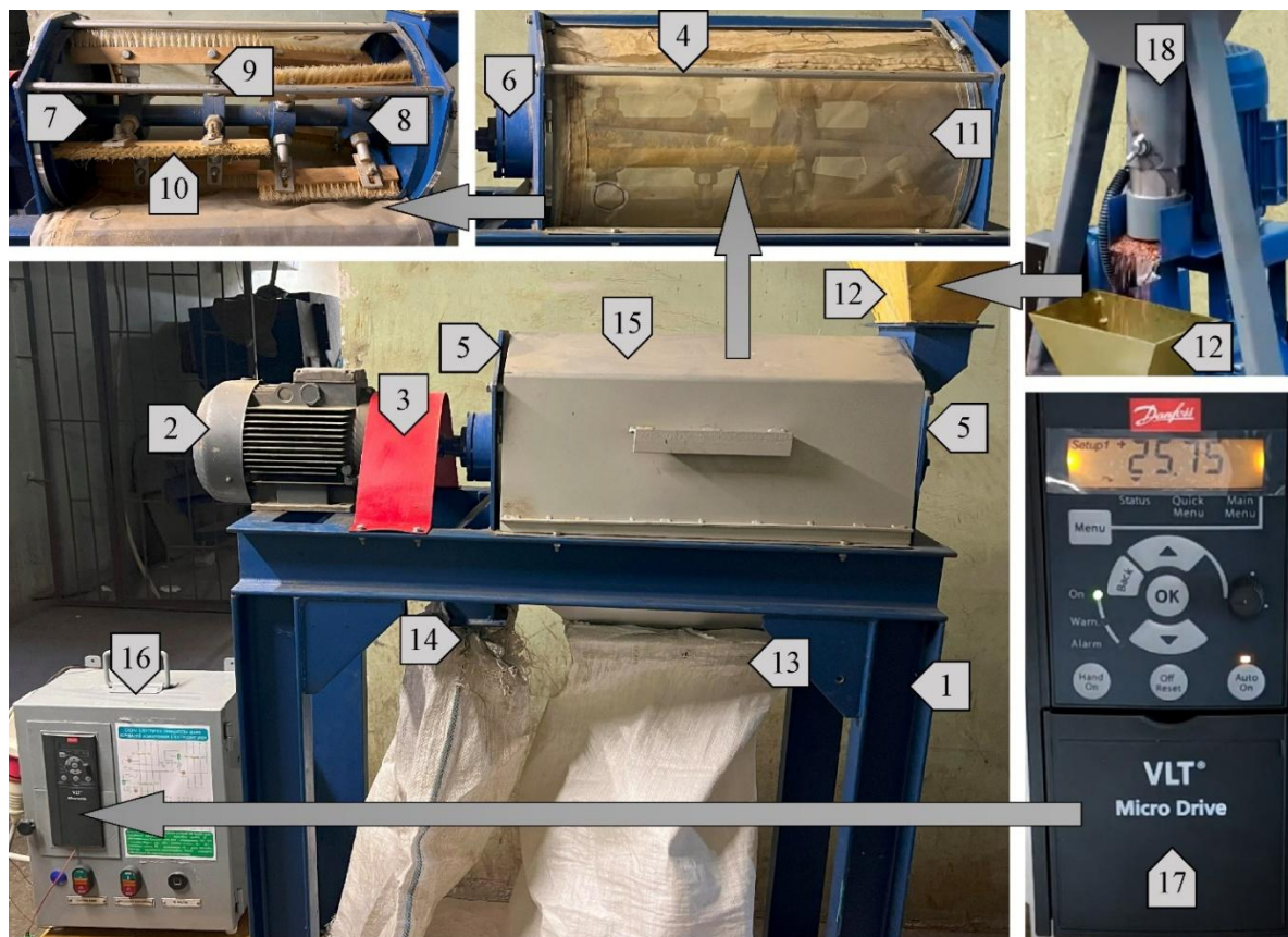
1 – рама; 2 – електродвигун; 3 – муфта; 4 – зовнішній корпус; 5 – бічна стінка; 6 – підшипниковий вузол; 7 – вал; 8 – бобишка; 9 – штифт з пластиною; 10 – щітка; 11 – сито; 12 – завантажувальний бункер; 13 – забірник дрібної фракції; 14 – забірник крупної фракції; 15 – кожух; 16 – щит керування; 17 – частотний перетворювач Danfoss Micro Drive; 18 – віброживильник
